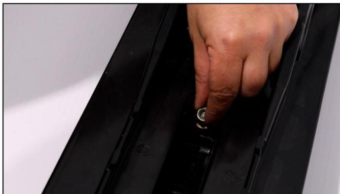
2.9 À l'aide d'une clé à cliquet, serrer les écrous en commençant avec l'écrou central, en serrant tous les boulons jusqu'à ce que la lisse se resserre sur le ski. Se référer au couple de serrage en fonction des écrous fournis avec le produit.
