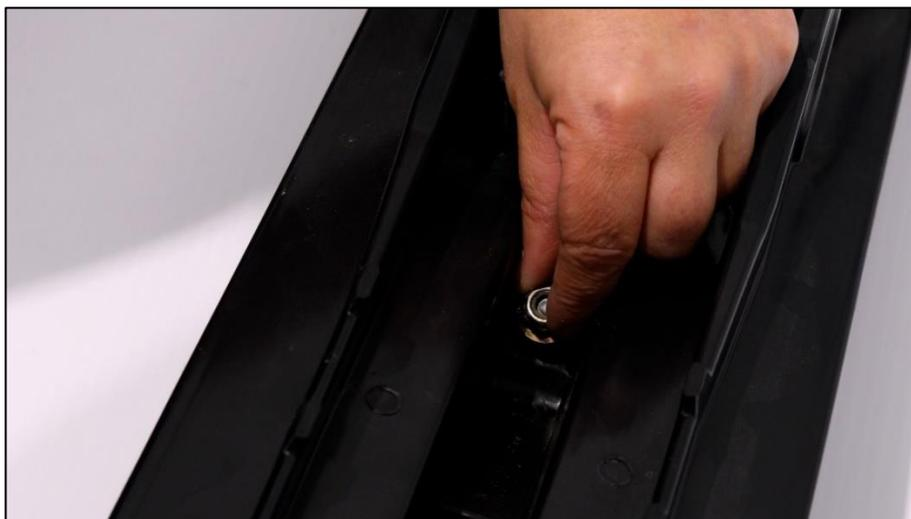
3.9 À l'aide d'une clé à cliquet, serrer les écrous en commençant avec l'écrou central, en serrant tous les boulons jusqu'à ce que la lisse se resserre sur le ski. Se référer au couple de serrage en fonction des écrous fournis avec le produit.
