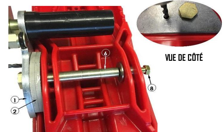
\* LES RONDELLES (#5) SERT À REMPLACER LE COUSSINET RETIRÉ À L'ÉTAPE B.
