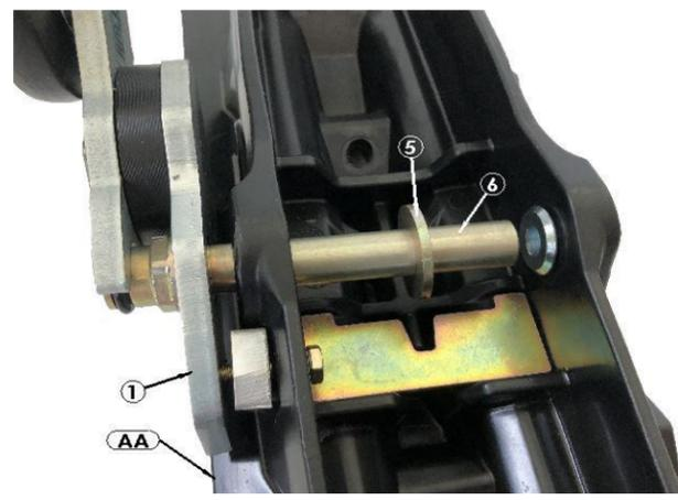
\*\* LA RONDELLE (#5) SERT À REMPLACER LE COUSSINET RETIRÉ À L'ÉTAPE B.
